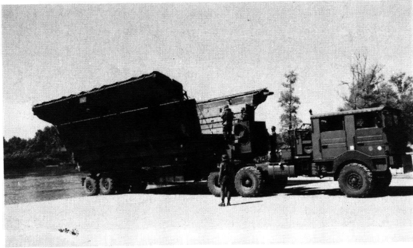
Le module se déploie sous l'action du groupe motohydraulique de la semi-remorque. (Photo Jean Mayet)
