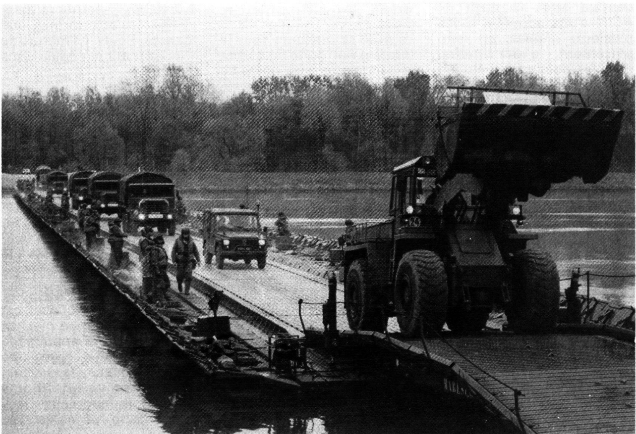
Le pont est fini: les véhicules peuvent passer (en tête du convoi un engin polyvalent du génie (EPG)). (Photo Jean Mayet)
