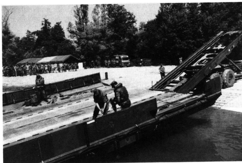
La partie basculante de la semi-remorque s'incline. Le module est mis à l'eau. Les moteurs hors bord sont installés. (Photo Jean Mayet)
