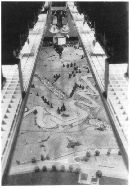
Maquette du terrain sur le simulateur de pilotage du char 68. Une mini-caméra orientable donne au pilote l'impression du terrain et provoque les mouvements du poste de pilotage.
