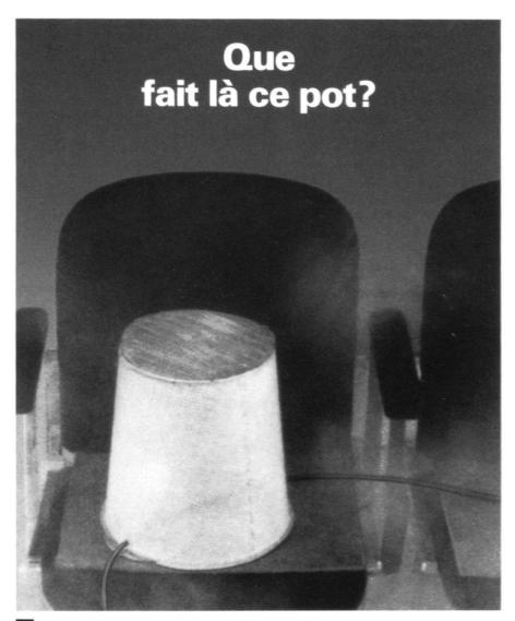
In fait, ce n'est pas un pot, mais un élément d'expérimentation servant à simuler le rayonnement thermique d'un être humain. C'est à l'aide de telles simulations que Sulzer résoud les problèmes que pose l'aération des grands locaux. De quoi éviter les pieds froids aux spectateurs des théâtres et aux auditeurs des salles de concert, les têtes chaudes aux étudiants dans les amphithéâtres et les gorges sèches aux orateurs.
