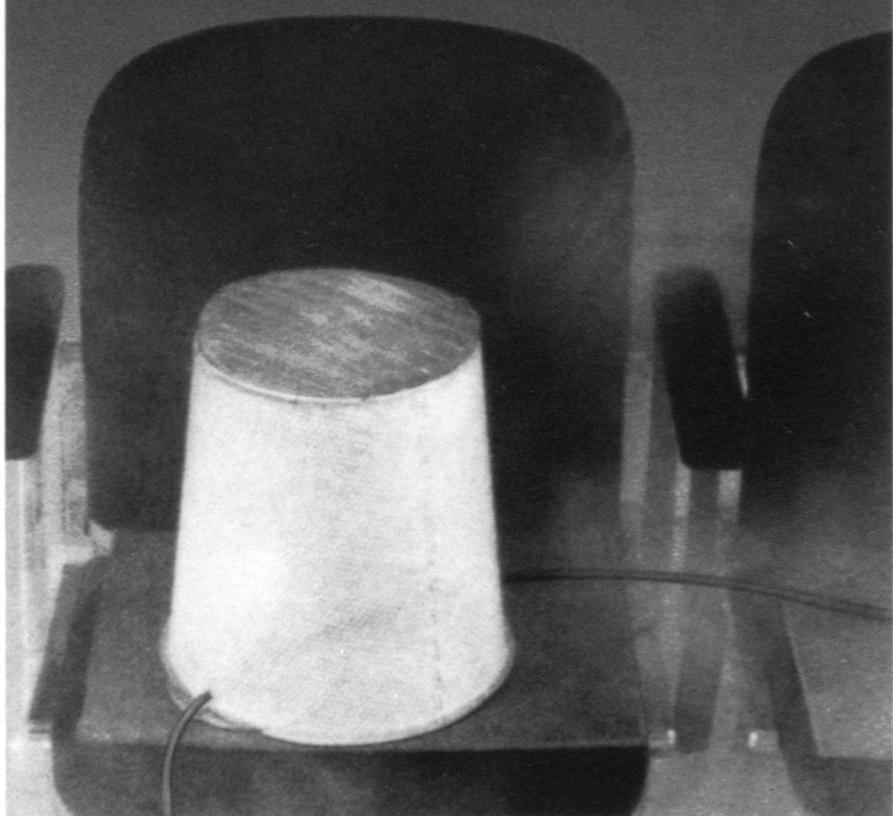
**E**n fait, ce n'est pas un pot, mais un élément d'expérimentation servant à simuler le rayonnement thermique d'un être humain. C'est à l'aide de telles simulations que Sulzer résoud les problèmes que pose l'aération des grands locaux. De quoi éviter les pieds froids aux spectateurs des théâtres et aux auditeurs des salles de concert, les têtes chaudes aux étudiants dans les amphithéâtres et les gorges sèches aux orateurs.
