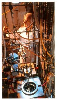
Station d'épuration pilote dans les laboratoires centraux de protection de l'environnement: elle sert à l'étude et à l'optimisation de la dégradation biologique des equi, usées
