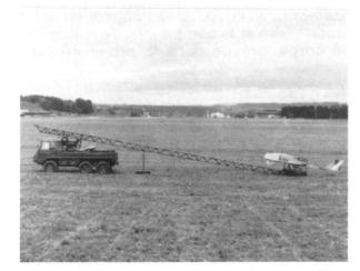
La rampe de lancement transportée sur un Pinzgauer. Le drone peut partir de n'importe quel terrain aux environs pas trop accidentés. Ici à proximité de la caserne de Drognens (photo cdmt ADCA).
