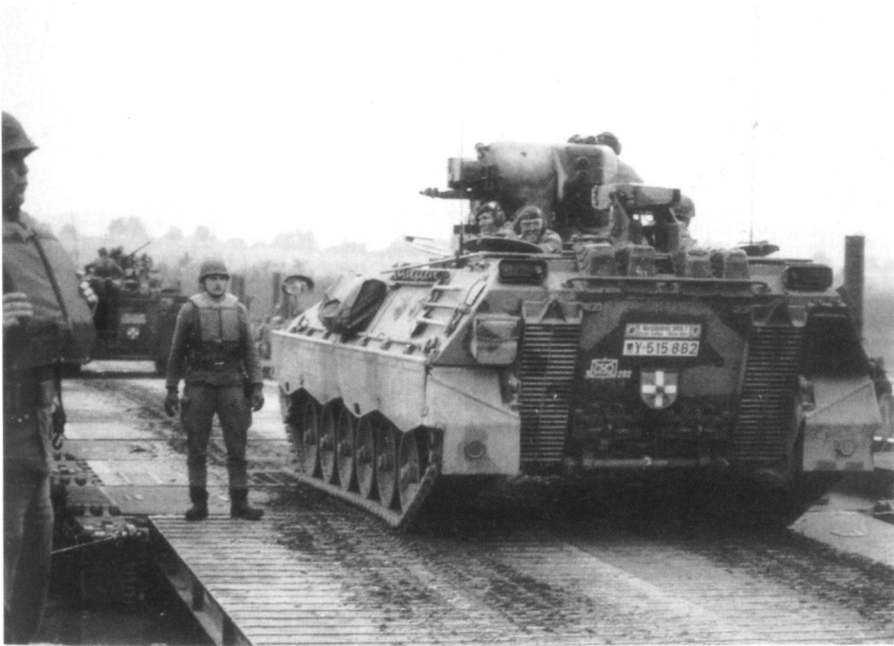
Confié à un équipage de quatre hommes et doté d'une tourelle à deux places, le «Marder MICV» peut transporter un détachement de six fantassins. Tous les «Marder» doivent être équipés de missiles «Milan».
