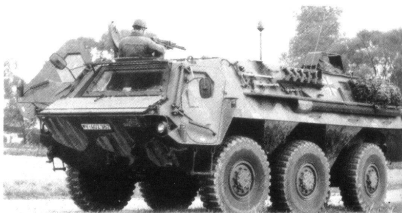
Le «Transportpanzer 1» peut servir de poste de commandement et de transmissions mobiles et de plate-forme de guerre électronique.
