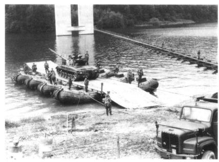
Le matériel des troupes du génie doit être modernisée. lci des éléments du pont flottant engagés comme bac. Le vieillissement de ce système est inquiétant...
