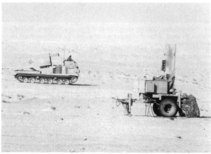
L'artillerie doit pouvoir intervenir dans la profondeur du dispositif ennemi. Il lui faut donc des moyens d'acquisition des objectifs (ici un radar de conduite du feu AN/TPQ-36 présenté à Dubai en octobre 1991), ainsi que des missiles d'artillerie. (Photo Hughes Electronics)
