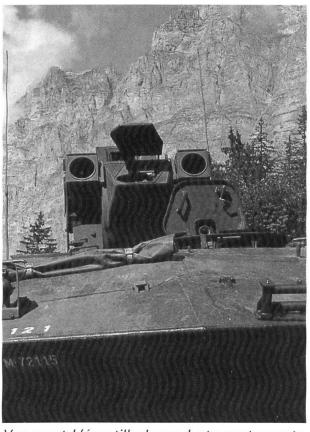
Vue avant. L'écoutille du conducteur est ouverte, de même que la plaque frontale de la tourelle. Les lance-missiles ne sont pas chargés. Le treuil est situé sur l'avant gauche
