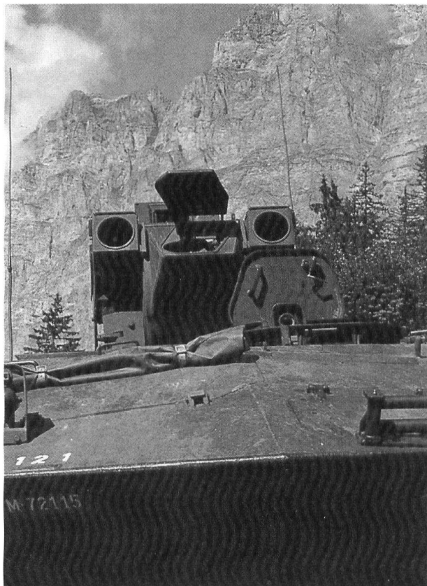
Vue avant. L'écouille du conducteur est ouverte, de même que la plaque frontale de la tourelle. Les lance-missiles ne sont pas chargés. Le treuil est situé sur l'avant gauche
