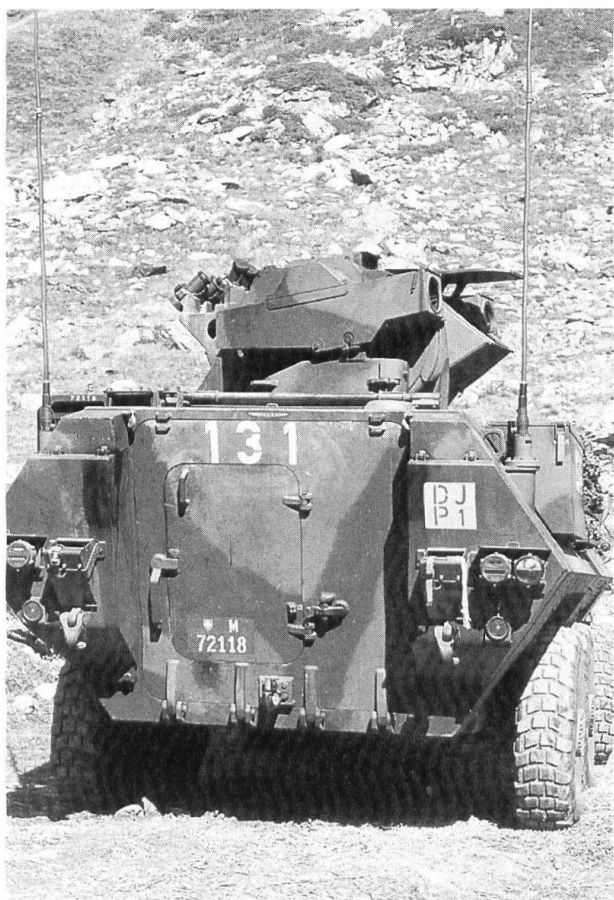
Vue sur l'arrière du Piranha. Noter les deux réservoirs à carburant, les crochets de remorquage et de traction, la porte arrière
