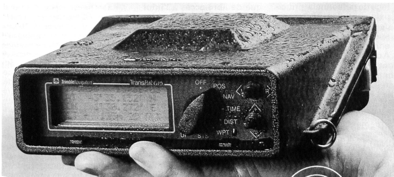
Le récepteur GPS TransPak , utilisé dans le Golfe à plus de 4500 exemplaires. Dimensions (mm): 165 x 178 x 50; masse: 1,5 kg; prix: environ $ 4000. (Document: Trimble Navigation)
