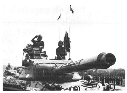
Sur cet AMX-30, qui reste encore aujourd'hui le char de combat des formations mécanisées françaises, on distingue la pièce principale, ainsi qu'à gauche, le système de visée du pointeur (le couvercle blindé est ouvert).
