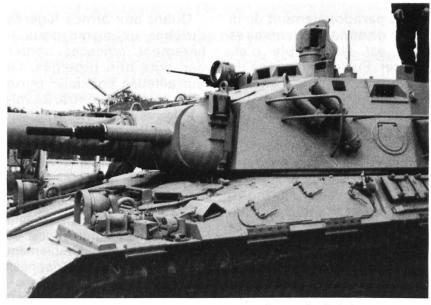
Un char de combat moderne dispose toujours, à côté de son canon dont le calibre varie entre 105 et 125 mm, d'une arme secondaire parallèle à la pièce principale. lci, sur cet AMX-32, on distingue le canon coaxial d'environ 20 mm, ainsi que la mitrailleuse DCA sur le tourelleau du comandant. Sur le côté de la tourelle, trois lance-pots fumigènes.
