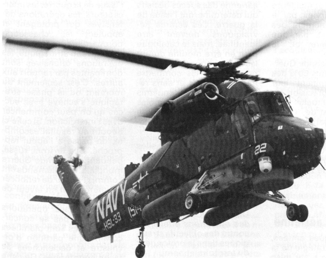
Les systèmes d'arme engagés contre l'Irak étaient aptes aussi bien au combat de jour que de nuit. Ici, un hélicoptère de l'US Navy équipé d'un dispositif de vision de nuit que l'on distingue au-dessous du poste de pilotage. (Photo Hughes Aircraft Company)
