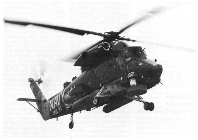
Les systèmes d'arme engagés contre l'Irak étaient aptes aussi bien au combat de jour que de nuit. lci, un hélicoptère de l'US Navy équipé d'un dispositif de vision de nuit que l'on distingue au-dessous du Poste de pilotage. (Photo Hughes Aircraft Company)
