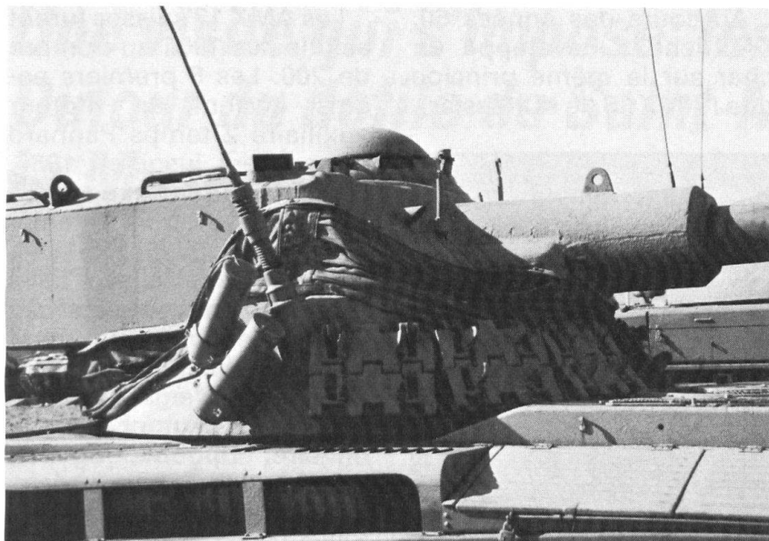
Vue générale du système oscillant de la tourelle. En effet, le canon bouge avec la partie supérieure de celle-ci, la délimitation se situant au niveau de la toile. Au premier plan, on remarque les coffres d'accessoires et une partie du pot d'échappement. Les galets fixés sur la partie inférieure de la tourelle servent également de protection supplémentaire. On aperçoit très clairement, le long du canon, la mitrailleuse coaxiale et l'orifice du système de visée. Les points d'ancrage pour la dépose de la tourelle sont aussi visibles sous cet angle.
