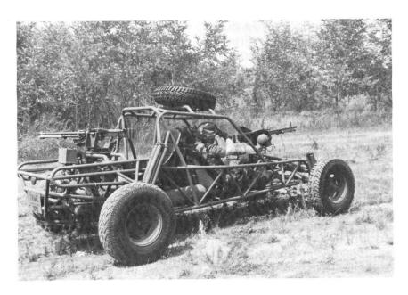
Tactique et art opératif: Le WARRIOR, utilisé par les forces spéciales US et britanniques engagées pour la recherche de renseignements, un véhicule léger, rapide, silencieux présentant une faible signature thermique et radar. Un concept de recherche de renseignements essentiellement dynamique. (Photo NORDAC)
