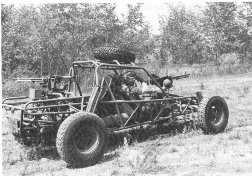
Tactique et art opératif: Le WARRIOR, utilisé par les forces spéciales US et britanniques engagées pour la recherche de renseignements, un véhicule léger, rapide, silencieux présentant une faible signature thermique et radar. Un concept de recherche de renseignements essentiellement dynamique. (Photo NORDAC)
