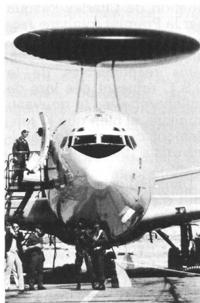
L'avion de détection électronique AWACS est équipé de radars d'une portée de 400 km, même lorsque l'appareil vole à basse altitude. Il peut détecter et suivre simultanément 300 objectifs. Trois de ces engins suffiraient à assurer la couverture radar totale du territoire français et de ses approches.
