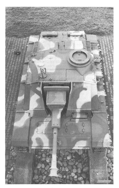
Vue générale du dessus de l'engin: on peut remarquer les plaques des différentes écoutilles du véhicule ainsi que les protections des grilles moteur. On distingue bien les différents éléments constituant le corps de l'engin.
