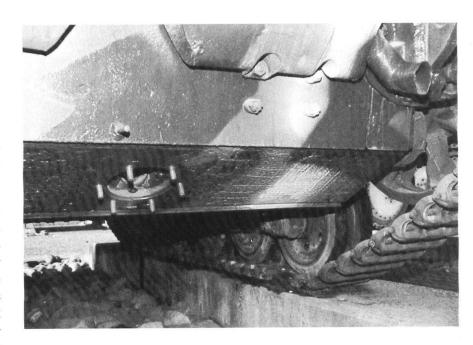
Traces de Zimmerit encore bien visibles. On peut aussi remarquer le pot d'échappement droit du véhicule.
