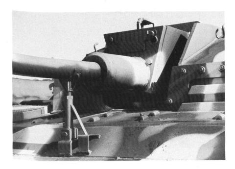
Le blindage additionnel boulonné est bien visible ainsi que le couvercle de protection de l'épiscope du pilote. Le masque du canon est particulier, car muni d'une mitrailleuse coaxiale. Les trappes sur le dessus de la caisse donnent accès à l'intérieur du véhicule, au mécanisme de direction et de freinage. Le support de marche est ici bien visible.
