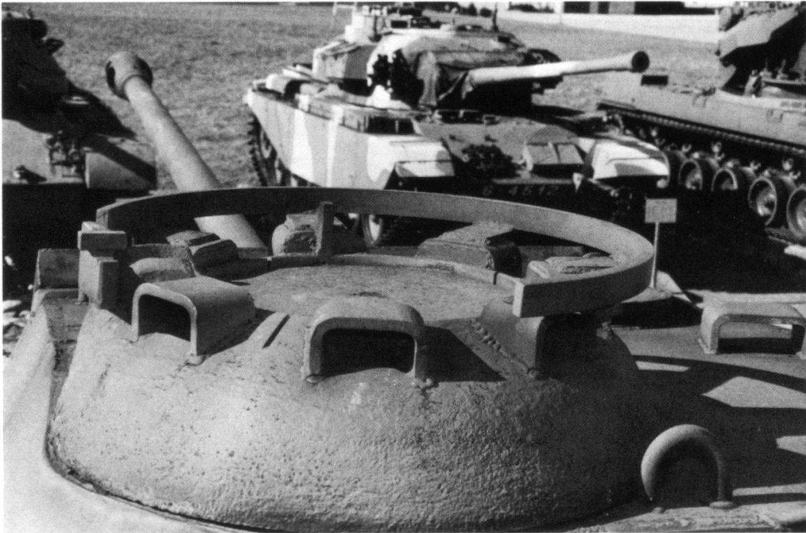
Gros plan sur le tourelleau du commandant (Rem. rail DCA).
