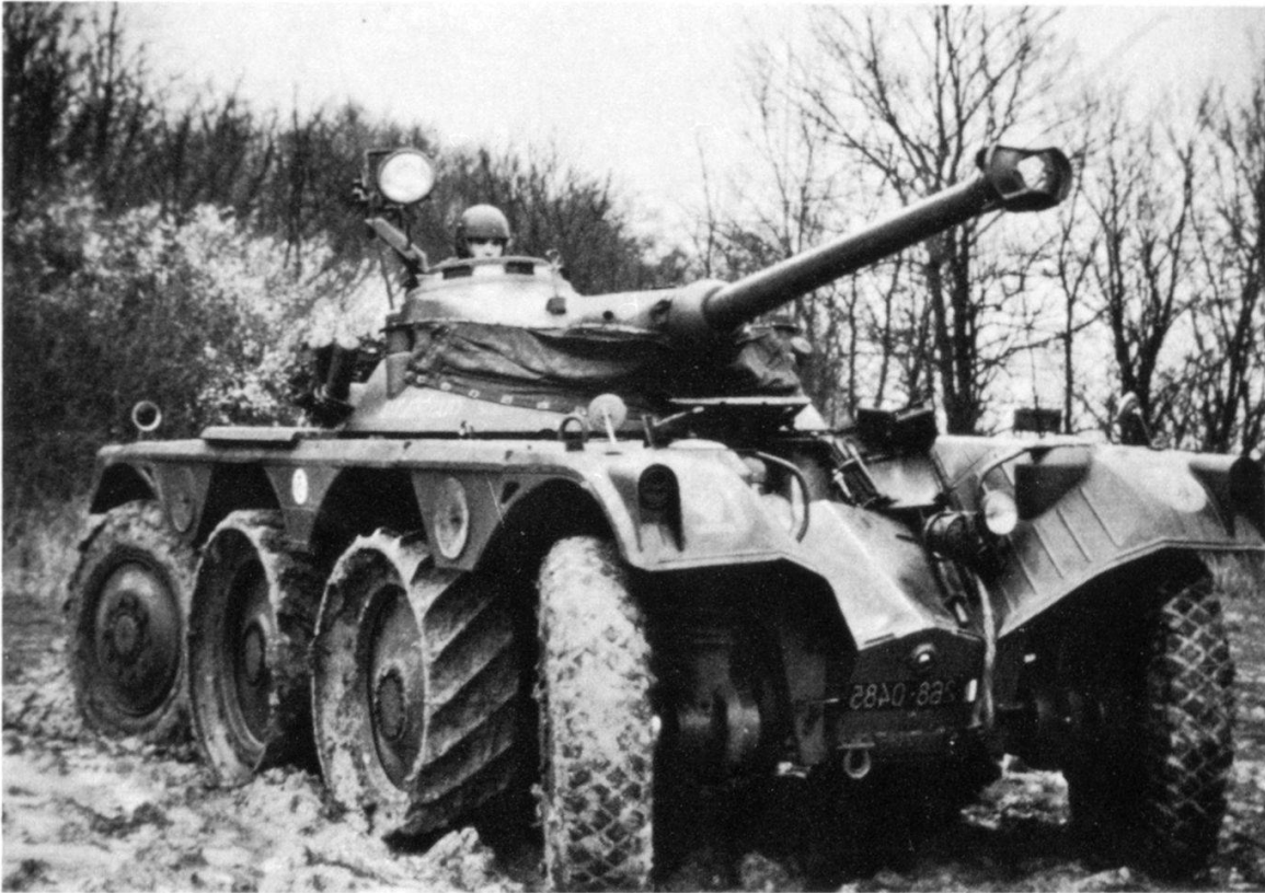
A remarquer sur ce cliché: le braquage des roues avant entraîne le contre-braquage des roues arrière
