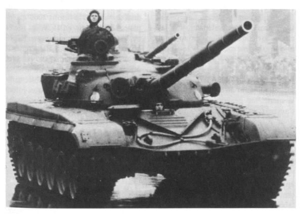
T-72 à un défilé. La pièce en V devant l'écoutille du pilote empêche l'eau d'atteindre le poste de pilotage, lors d'un passage à gué. A droite de la tourelle, le schnorchel.
