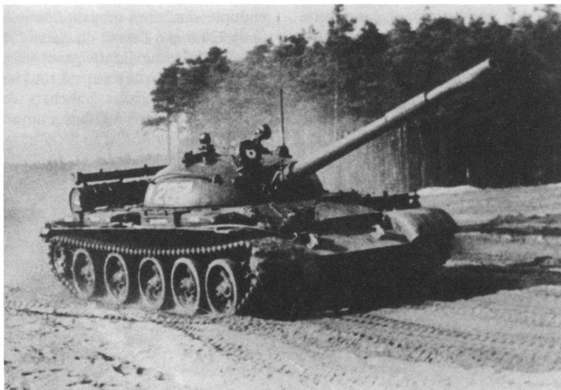
Sur ce T-62, on distingue à l'arrière les deux réservoirs supplémentaires, ainsi que le schnorchel qui peut équiper le char pour les franchissements.
