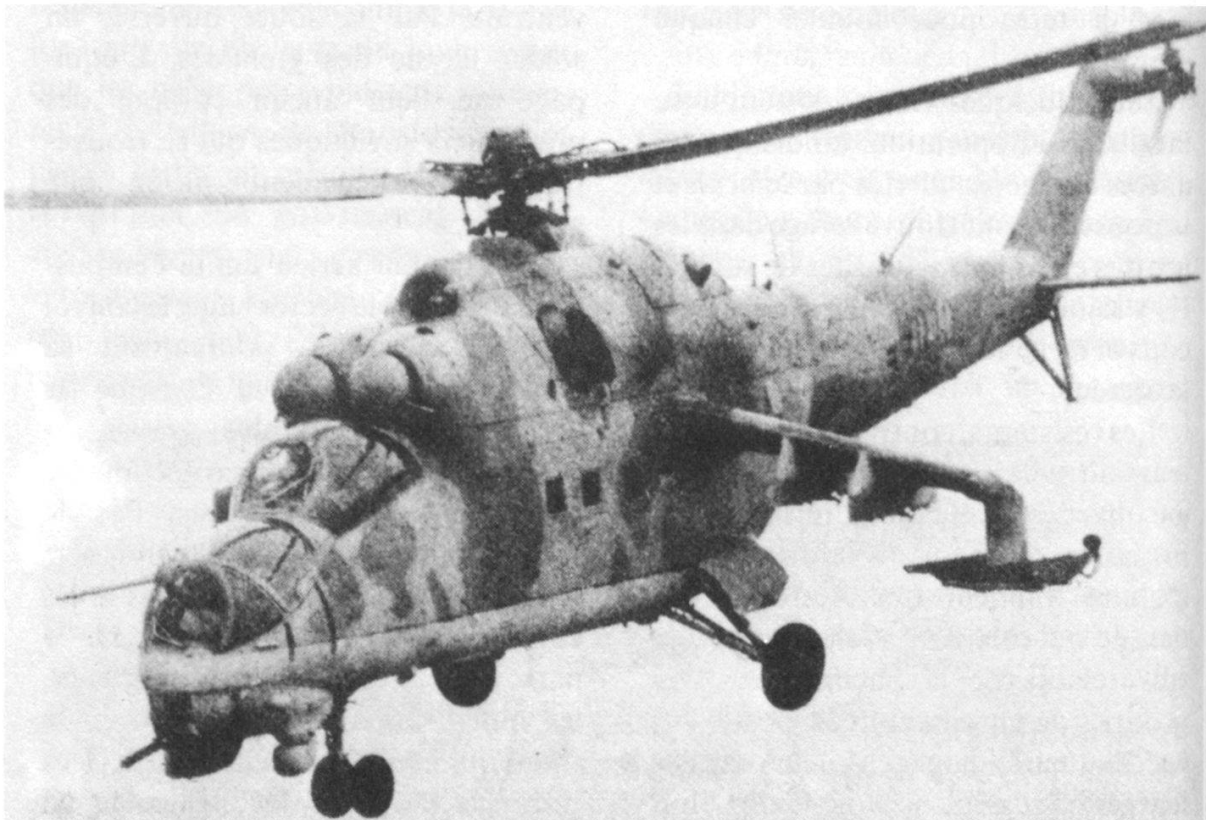
L'hélicoptère de combat Mi-24 . A gauche, on distingue les supports pour l'armement, ainsi qu'une mitrailleuse sous le nez de l'appareil.
