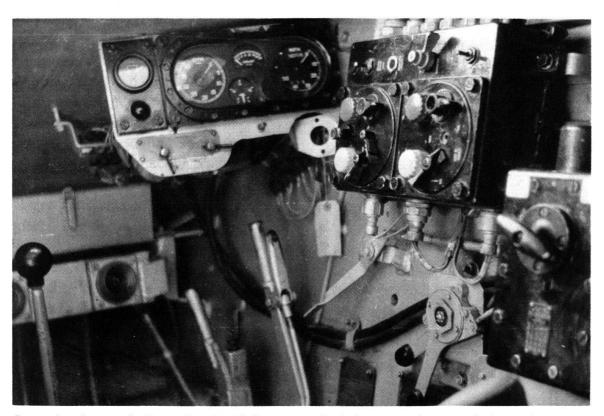
Poste de pilotage du Centurion Mark 7. De gauche à droite, on distingue le levier de vitesse, le levier de direction droite, le frein à main. Pour monter et descendre les vitesses, il faut un double débrayage. Il faut une force de 40 kg pour manœuvrer la pédale d'embrayage.
