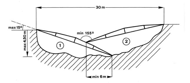
Le système peut être étendu à l'infini. Il est notamment possible, avec trois ponts, de franchir 40 m.
