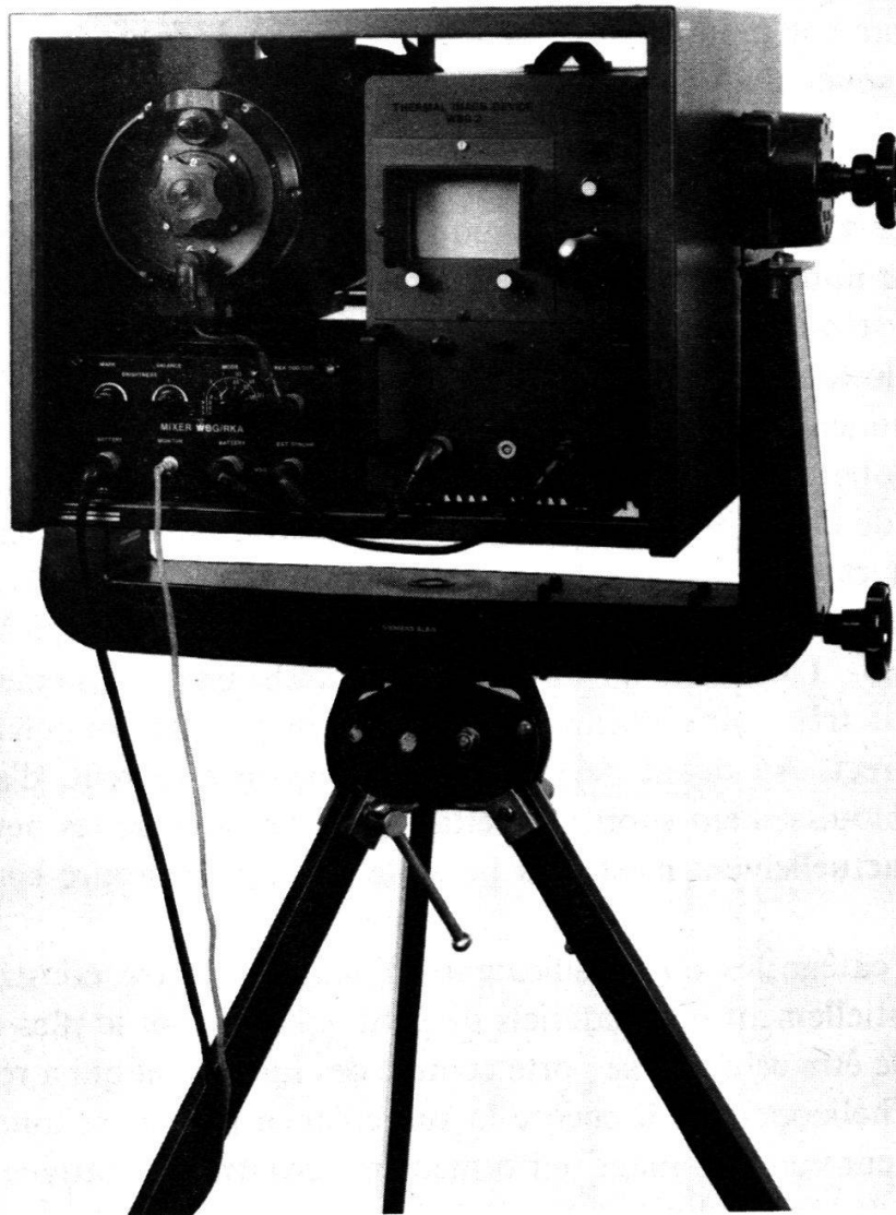
Thermoviseur prêt à l'emploi, sur trépied. L'image apparaît sur l'écran. (Siemens-Albis)
