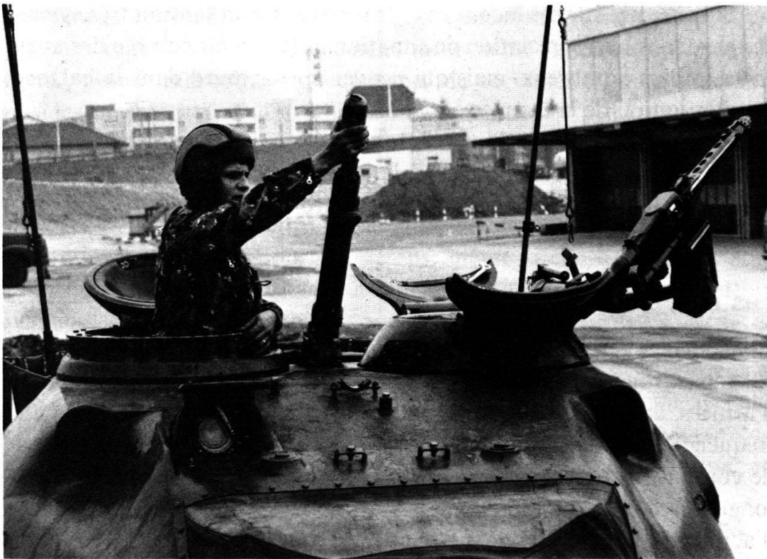
Chargement de l'obus éclairant «Lyran» qui équipe maintenant tous nos chars blindés. Ici, nous voyons le chef d'un char suisse 68 de la dernière série effectuer cette opération.
