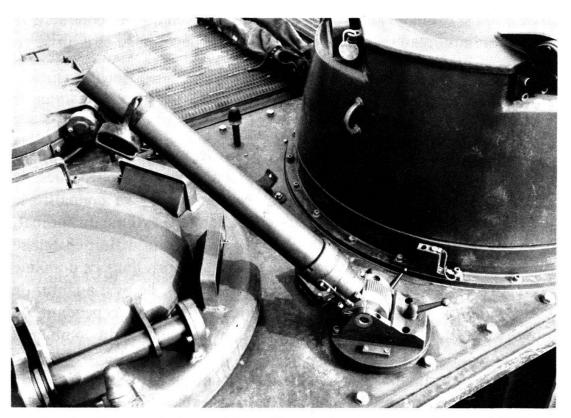
Le tube «Lyran» a également été installé sur le char transporteur de troupe M 113.
