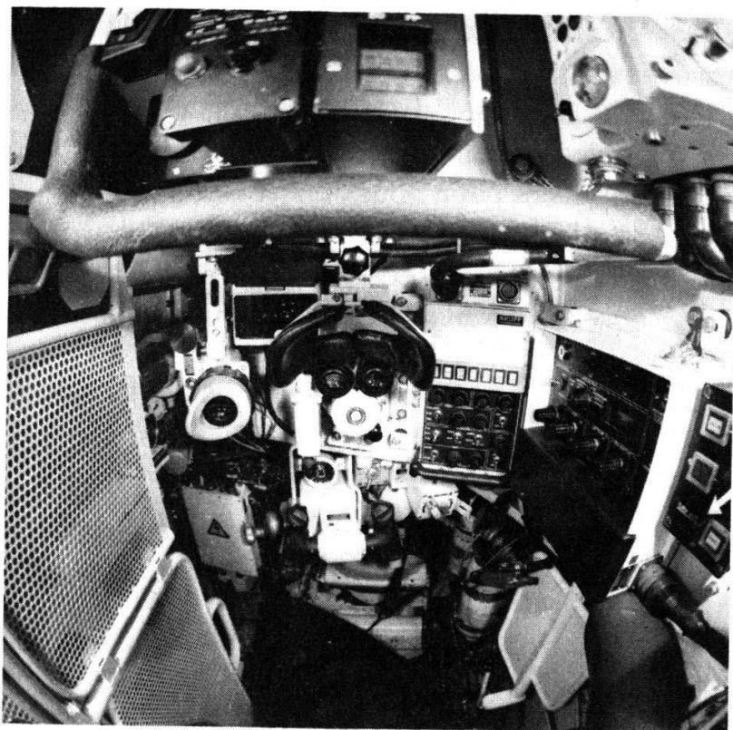
Vue intérieure du poste de pointage (tireur). Au centre, le binoculaire de visée et en dessous la commande du canon.
