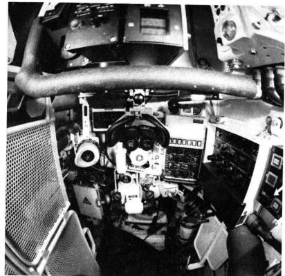
Vue intérieure du poste de pointage (tireur). Au centre, le binoculaire de visée et en dessous la commande du canon.
