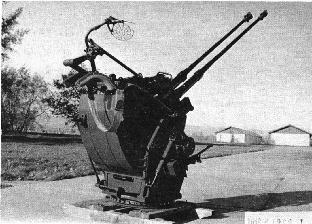
Figure 6. — Canon DCA 20 mm 54 sur socle «Zwilling».
