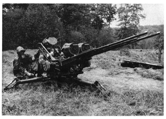
Figure 7. — Canon DCA 20 mm 43/57 « Drilling ».
