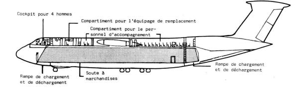
la possibilité de «se mettre à genoux». Cela permet d'adapter la hauteur de la soute à marchandises au moyen de transbordement.
