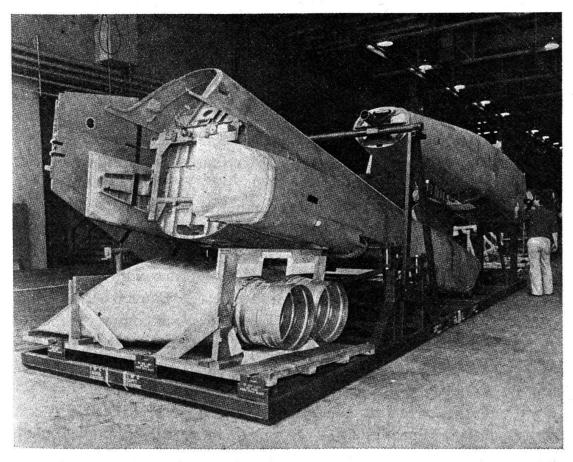
Pour le montage final en Suisse les groupes de construction principaux d'un avion sont emballés dans des conteneurs spéciaux puis conduits en avion de Californie à Emmen.
