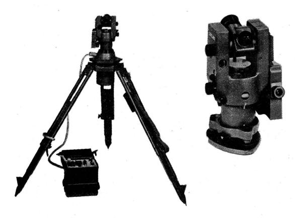
Sous l'effet de la rotation de la terre, le compas gyroscopique se place dans la direction du nord géographique. Ce réglage, qui s'opère automatiquement, est reporté par voie optique et électrique à la lunette incorporée à l'appareil. Le système peut être alimenté par accumulateur propre ou une source externe d'énergie de 12 ou 24 volts.
