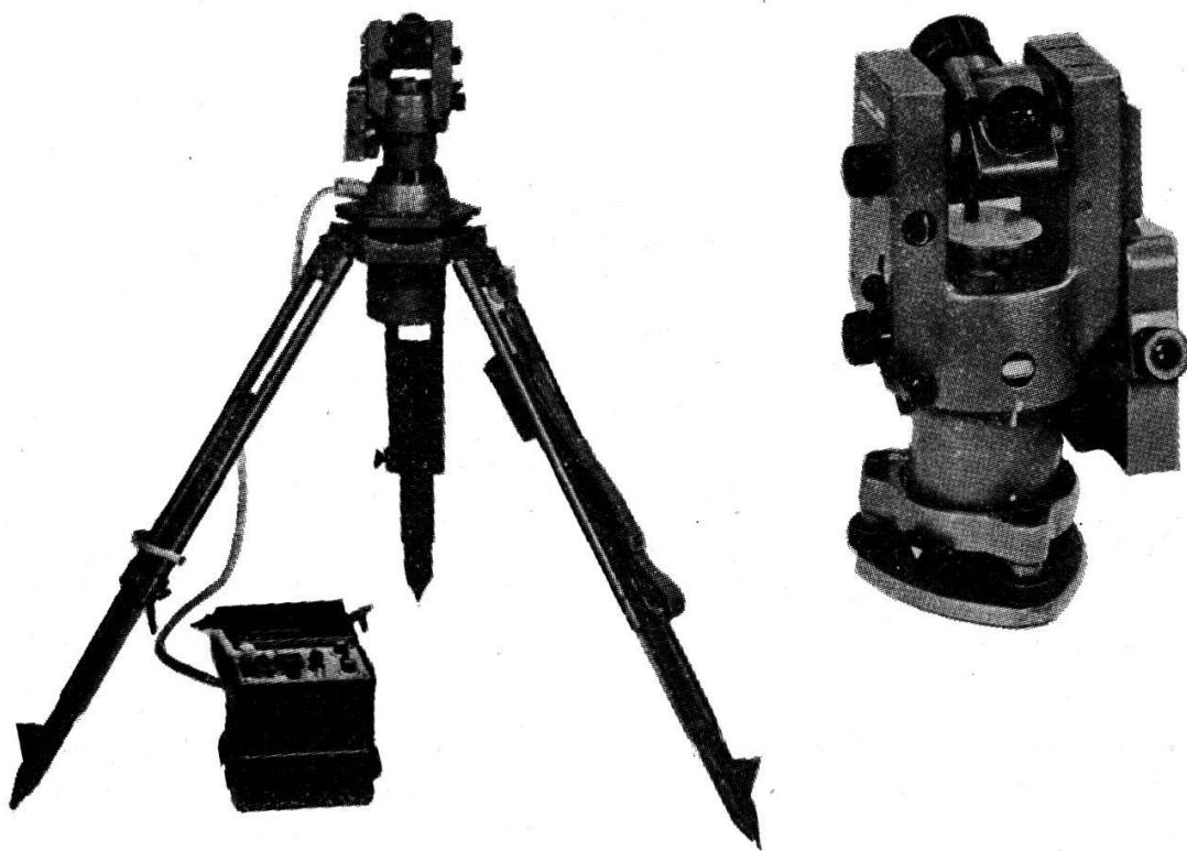
Sous l'effet de la rotation de la terre, le compas gyroscopique se place dans la direction du nord géographique. Ce réglage, qui s'opère automatiquement, est reporté par voie optique et électrique à la lunette incorporée à l'appareil. Le système peut être alimenté par accumulateur propre ou une source externe d'énergie de 12 ou 24 volts.
