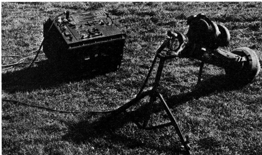
Simulateur de lancement muni de l'instrument de visée et lié à l'appareil de surveillance
