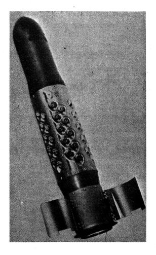
Engin filoguidé de guerre avec ailettes relevées. On voit nettement les fusées à combustible solide qui selon le besoin sont allumées aux fins de la propulsion et des corrections de direction.
