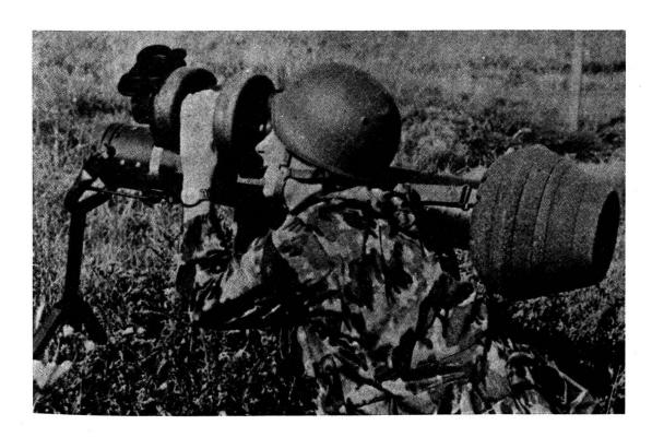
incorporé à l'instrument de visée. Un calculateur détermine les corrections nécessaires et les transmet par un fil à l'engin guidé où s'allument au moment opportun de petites fusées de commande. Ce mode de guidage permet de combattre avec une grande précision des chars en mouvement. Au moment où l'engin filoguidé touche le but, une charge creuse est mise à feu. Cette charge perce tous les blindages actuellement en usage.
