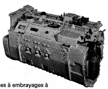
Boîte de vitesses à embrayages à lamelles avec appareil additionnel hydrostatique de direction
