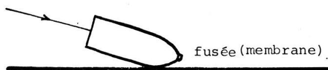
Si l'angle d'incidence est vraiment trop rasant, la membrane ne percute pas et l'obus va au diable.
