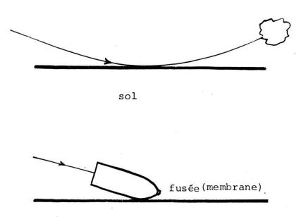
Si l'angle d'incidence est vraiment trop rasant, la membrane ne percute pas et l'obus va au diable. Personnellement, je pense que ce tir doit être « panaché », parce que la dureté du sol est sujette à des changements difficiles à « normer», et qu'il ne faut pas dépendre exclusivement de l'efficacité toujours un peu aléatoire du ricochet.
