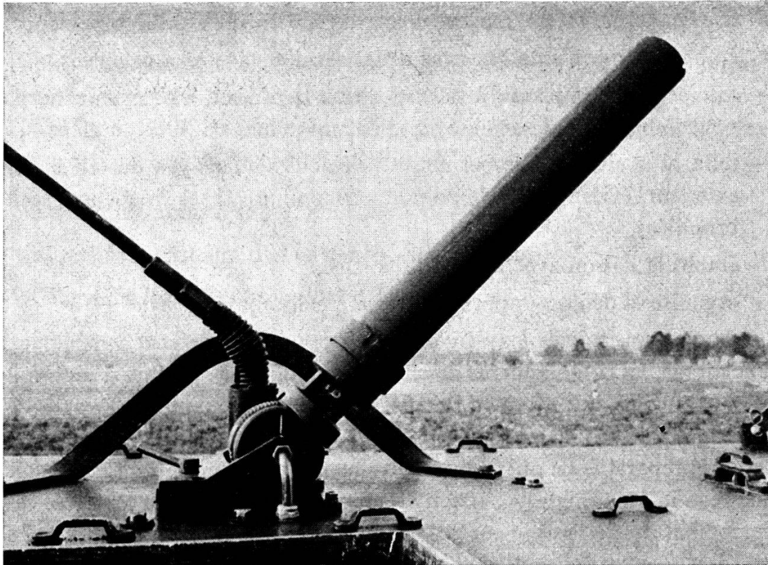
Tube Lyran monté sur châssis M 113.
