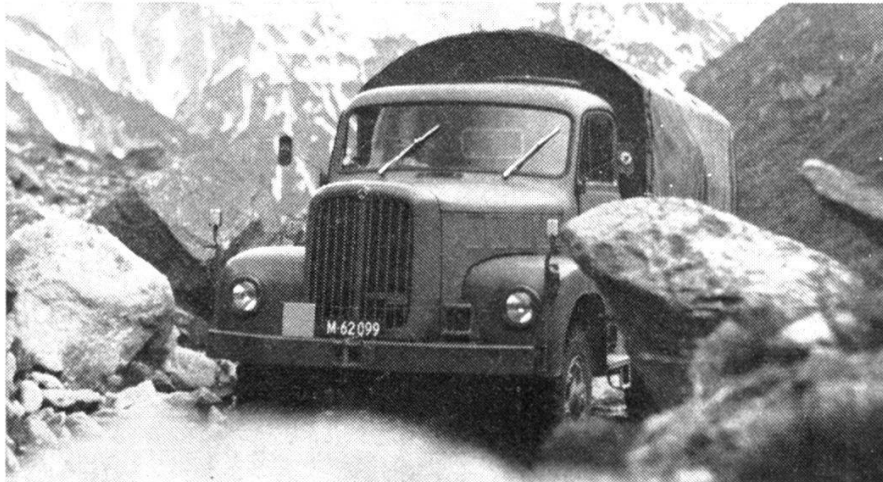
Camion Saurer-Berna à traction intégrale, type 2DM/2VM, en service depuis 1964 comme camion et basculeur.
