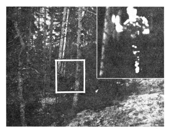
Figure 4. — A gauche: Photo normale d'un soldat camouflé derrière d'épais buissons et invisible à l'œil nu. A droite: Par le moyen de la thermovision, le soldat apparaît clairement, en particulier les parties de son corps (les bras) qui sont découvertes. (Protos prises à environ 75 mètres.)
