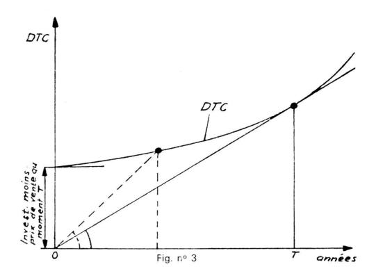
moment où cette droite touche tangentiellement la courbe DTC. C'est en ce point tangentiel, qu'il faut vendre ou remplacer le matériel. Bien que cette méthode néglige la valeur utilitaire et ses changements, elle a l'avantage d'être simple et de permettre de déterminer le moment optimum de remplacement d'un matériel, en ne dessinant que la courbe statistique des dépenses totales cumulées.
