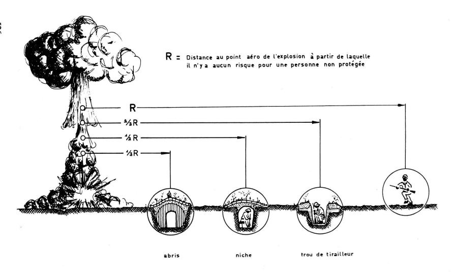
FIG 1: EFFET DE MESURES DE PROTECTION CONTRE UNE ARME A
