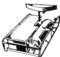
BT 18 But infanterie radioguidé. Les coups portants sont marqués par la chute automatique du but.
