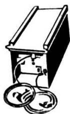
BT 16 Marqueur lumineux pour marquage automatique des coups portants.
