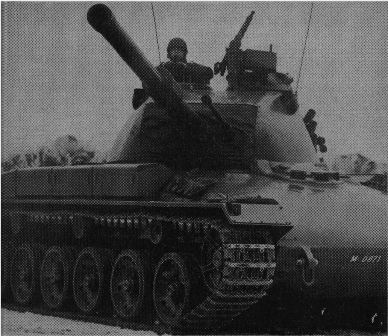
Le char suisse 61 est en voie d'introduction. Il est doté d'un canon de 10,5 et, en outre, d'un canon de 20 mm à tir rapide.
