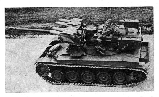
L'AMX 13 tonnes équipé de SS-11 à télécommande automatique; le coffre surélevé derrière le tireur sert au guidage des engins. Photo E.C.A.
