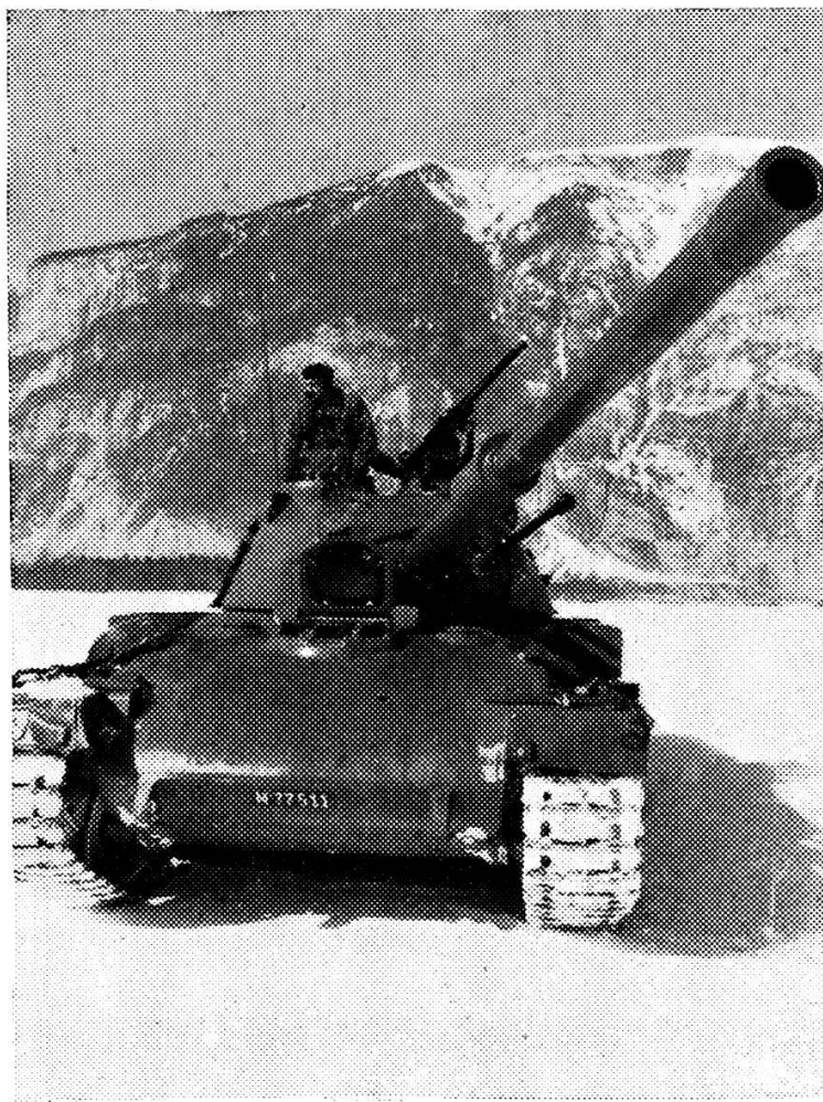
Le char 61 avec son canon de 10,5 cm, le canon automatique de 20 mm parallèle au tube et la mitrailleuse 51, de 7,5 mm affûtée sur la tourelle. Le Calanda au fond offrait une sécurité absolue pour des exercices de tir, mais les grands calibres et la munition de guerre sont interdits.
