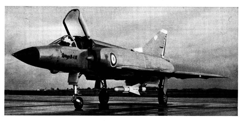
Fig. 2. — Engin MATRA R. 530 sous un « Mirage » III.
