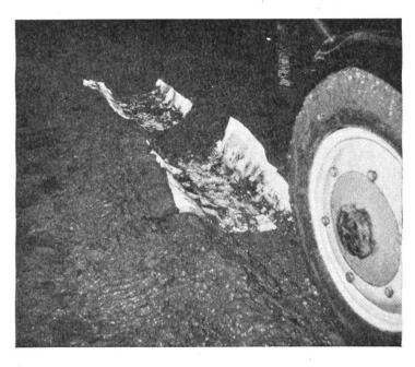
Ces cartes topographiques, imprimées sur SYNTOSIL, passées plusieurs fois sous les roues d'un tracteur lourd, sont pourtant demeurées intactes.
