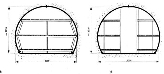
Fig. 4 g. — Abri-tunnel avec couchettes et fond en métal léger.
