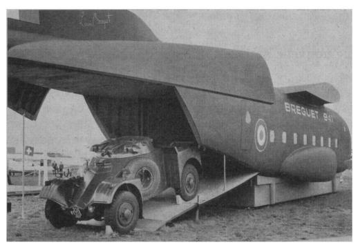
AML Panhard sur maquette de Breguet 941 de transport. Sont particulièrement visibles : les épiscopes devant l'emplacement du conducteur (l'engin peut plonger dans l'eau jusqu'au niveau de ceux-ci) et sur la tourelle ; il n'apparaît que le haut de celle-ci, pivotant en entier jusqu'au plancher du véhicule.
