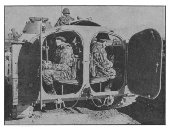
Fig 3. — Véhicule blindé tout-terrain à l'étude pour le transport des grenadiers
