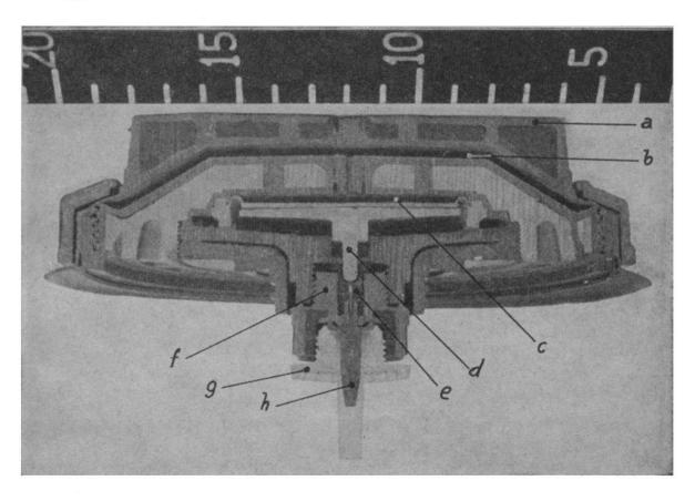
Fig. 4. — MINE SH.55 — Dispositif de fonctionnement en coupe.
