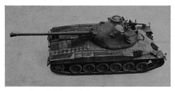
Fig. 1. Le P 58 en marche, le canon tourné vers l'arrière et placé sur un support.
