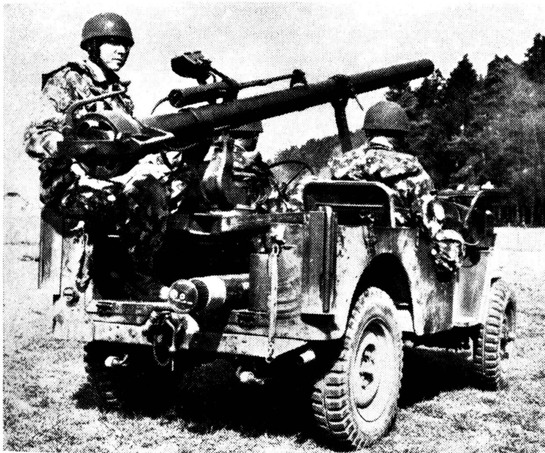
FIG. 1. — L'arme anti-tanks « Bat » 106 mm. montée sur une jeep. Elle peut être installée à terre en quelques instants.
