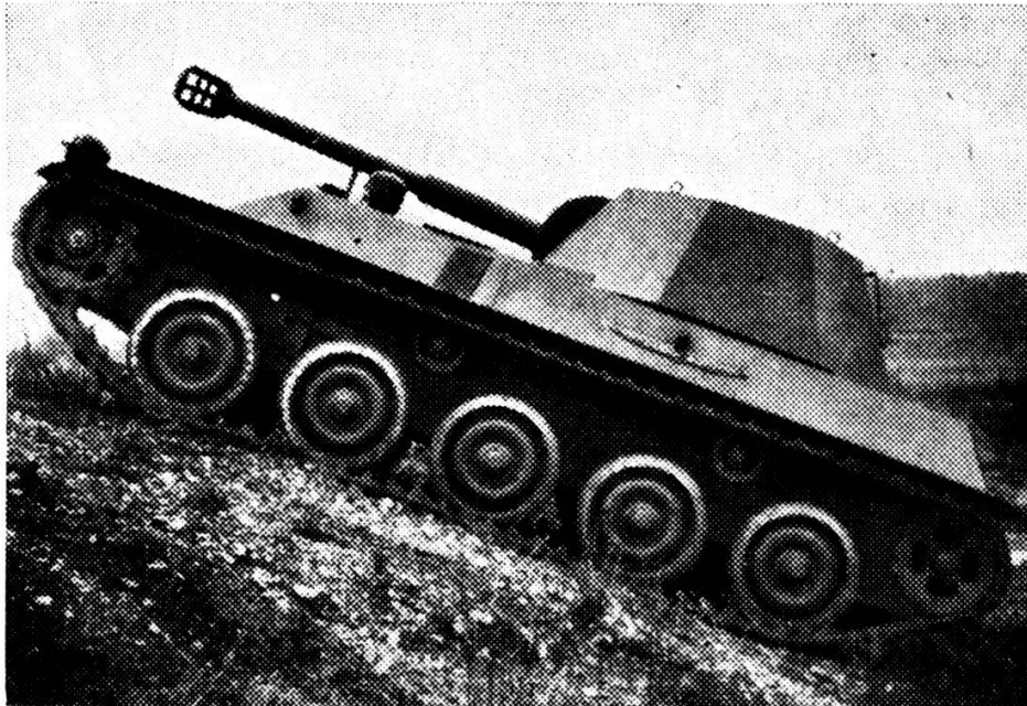
FIG. 4. — Essai suisse d'apporter une solution au problème de la mobilité des armes d'appui (affût automoteur à usages multiples «PIRAT»).
