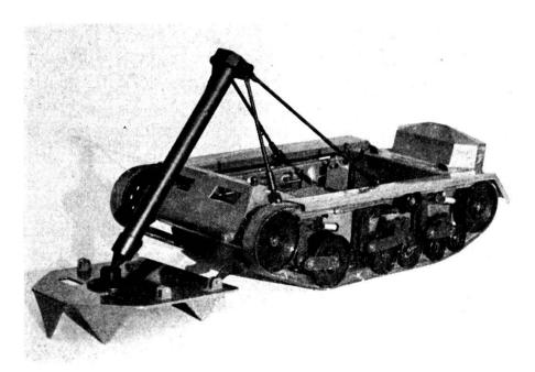
Fig. 3. — Type d'engin porte-mortier chenillé.
